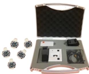
Figura 4.4. Sistema de medición electromiográfica “Shimmer”.
